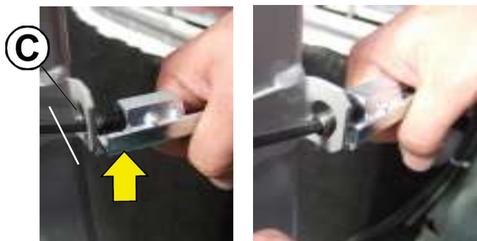
- Suba un poco el bloque posterior de los quemadores y saque los 2 pernos con llave hexagonal de 5 mm, hasta llegar a los agujeros "C" (lado izquierdo y derecho).
